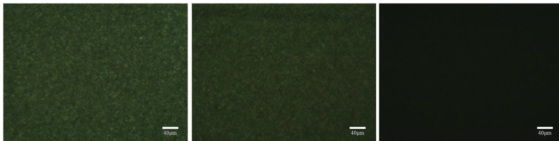
图 2 PDLC 膜光学显微照片.(a) 60\text{ }^{\circ}\text{C} ; (b) 70\text{ }^{\circ}\text{C} ; (c) 80\text{ }^{\circ}\text{C}
